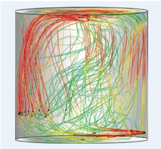
通过三维计算机模拟优化圆柱形食用油储罐内的混合条件。垂直剖面; 颜色图像中混合流态的空间分布。
