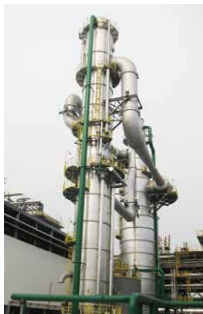
双塔式 3 级逆流桥式设计，自立结构
