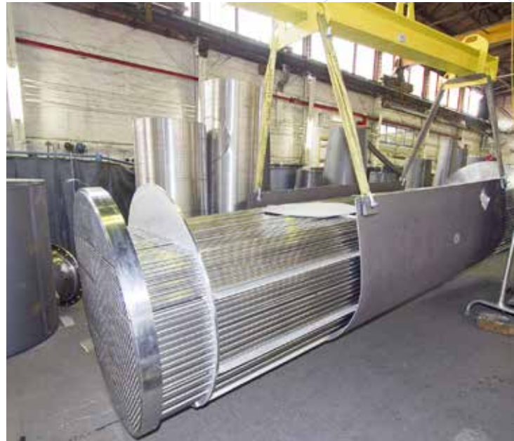
德国汉诺威工厂炼油装置冷凝器组装
